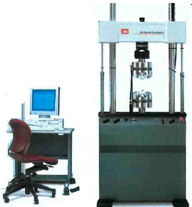
Figura 8.1 - Máquina de testes dinâmicos MTS 810 (10) .
